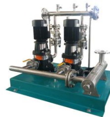
变频恒压供水设备两台泵 (304不锈钢、紫外线消毒器)
